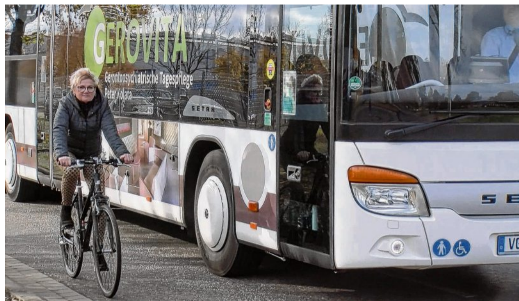
Die neuen Abbiegeassistentensysteme erkennen Verkehrsteilnehmer, die sich unmittelbar neben dem Fahrzeug befinden. FOTO: ZVG
